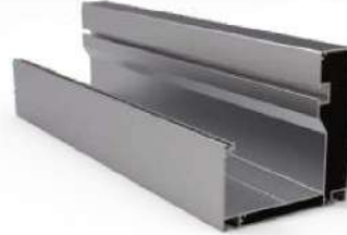
Büyük Su Oluğu Profil Large Water Gutter Profile Profile Nr : 2078 Weight kg/m: 4,398 (150 x 152 x 2,2mm)
