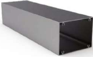
110 x 145 Dinek Profili 110 x 145 Column Profile Profile Nr : 2111 Weight kg/m: 3,044 (110 x 145 x 2mm)
