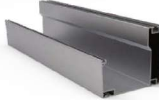
Küçük Su Oluğu Profil Small Water Gutter Profile Profile Nr : 5935 Weight kg/m: 3,916 (120 x 164 x 2,5 mm)
